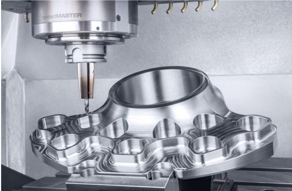
Der modulare Baukasten der DMU 85 monoBLOCK 2. Generation umfasst speedMASTER Spindeln mit Drehzahlen von 30.000 min<sup>-1</sup> für die Bearbeitung perfekter Oberflächen oder drehmomentstarke Spindeln mit bis zu 430 Nm für die Schwerzerspannung von Titanbauteilen
